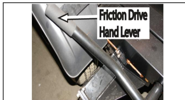
Figura 24 – Pârghia manuală cu frecare
